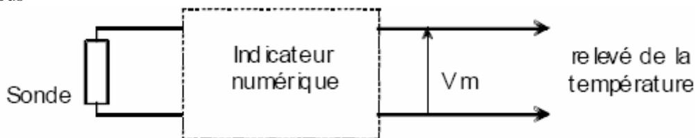
La tension  $V_m$  est disponible sur la sortie de recopie de mesure de l'instrument.
