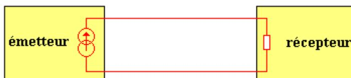
de courant présente une **meilleure immunité aux bruits** (parasites). L'intensité du courant est indépendante de la résistance du câble, ce qui autorise de **grandes longueurs de ligne** de transmission (quelques centaines de mètres). La boucle 4-20mA présente un intérêt supplémentaire dans la mesure où elle permet une **détection "ligne coupée"** (courant nul, donc hors échelle).
