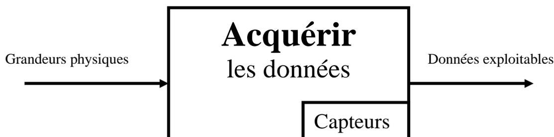
Les capteurs vont devoir acquérir et convertir en informations exploitables par un système automatisé, des grandeurs physiques.
