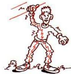
Fig. 1 : Contact direct entre conducteur nu sous tension et la terre.
