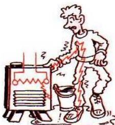
Fig. 3 : Contact indirect, masse mise accidentellement sous tension.
